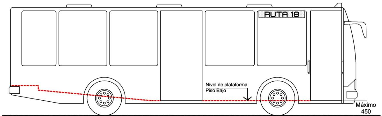
**Imagen 4.** Vista explicativa lateral: Autobús de Piso Bajo con ASP máximo de 450 mm.
