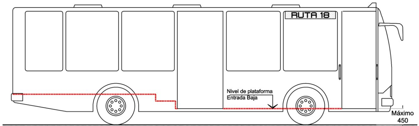
**Imagen 3.** Vista explicativa lateral: Autobús de Entrada Baja con ASP máximo de 450 mm.
