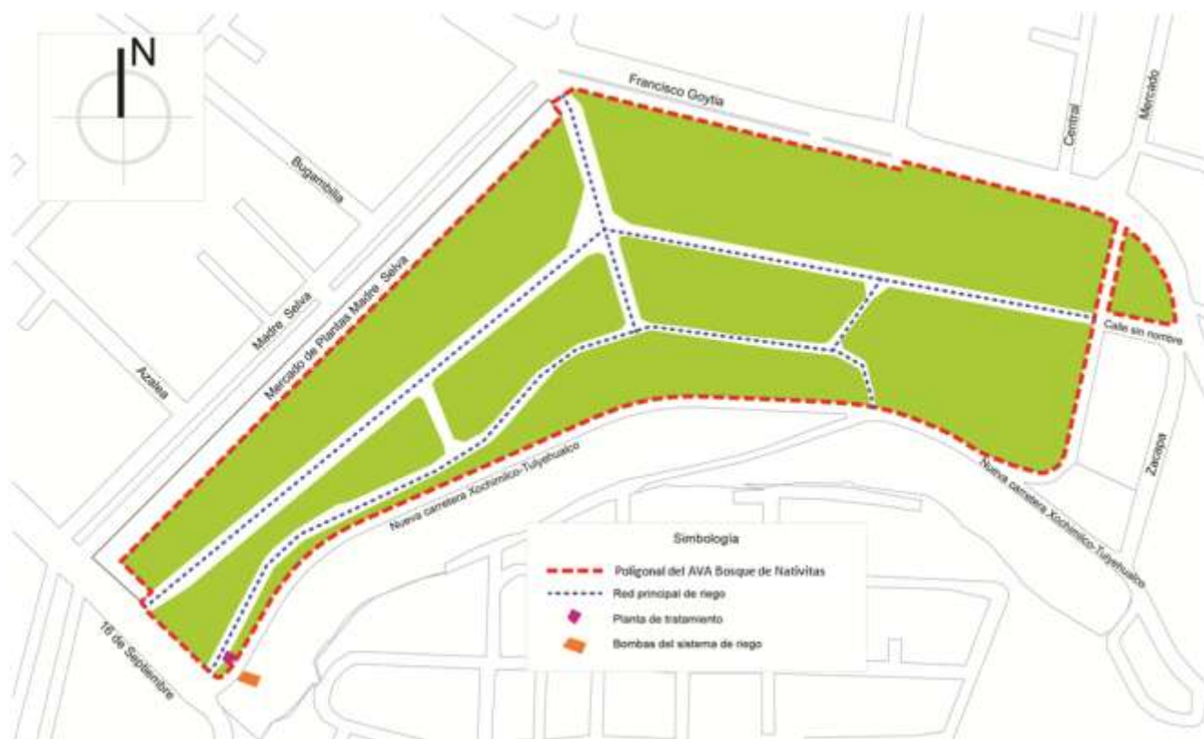
Figura 12. Ubicación de la red de riego y planta de agua tratada dentro del AVABN.
