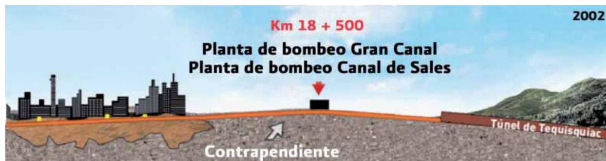
Figura 5. Efecto de los hundimientos en la Ciudad de México y condiciones de trabajo del GCD (SEMARNAT, 2012).
