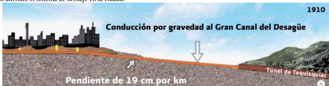
Figura 4. Diseño original del Gran Canal del Desagüe (GCD) y hundimiento de la Ciudad (SEMARNAT, 2012)
