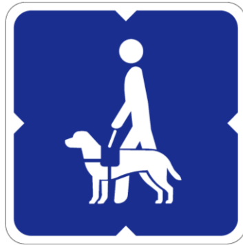
Imagen 22. Señalización visual que se requiere incorporar para identificación del área designada para persona acompañada por perro de asistencia, tamaño 150 mm por 150 mm, colocada sobre ventanilla adyacente.
