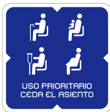
Imagen 21. Señalización visual que se requiere incorporar para identificación de los asientos designados para personas con movilidad limitada, tamaño 150 mm por 150 mm, colocada sobre ventanilla adyacente.
