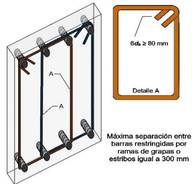
Figura C8.3.4 – Ejemplo de estribos sobrepuestos en una viga
