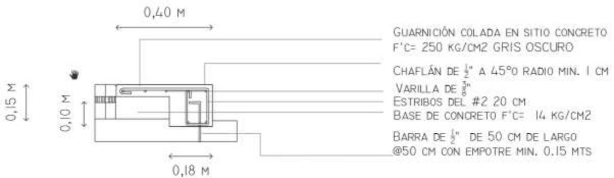
Detalle constructivo de guarnición tipo.
