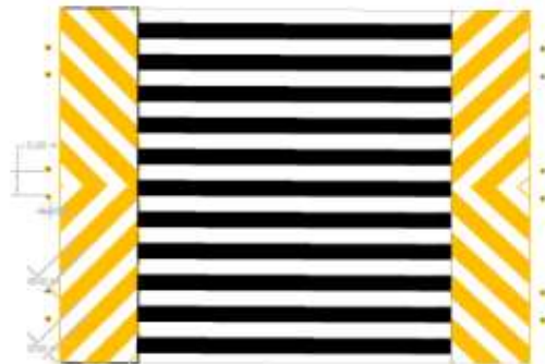
BALIZAMIENTO Y COLOCACIÓN DE BOTONES REFLEJANTES AMARILLOS
