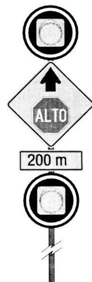
**F10-s.** Semáforo de destello para indicar peligro o precaución con una señal luminosa.
