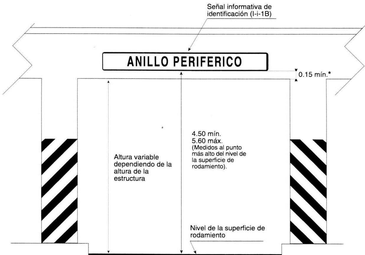
**F16-ci.** Colocación e instalación de las señales independientes elevadas adosadas a muros (Señales de identificación).
