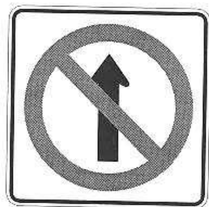
R-28 Prohibido seguir de frente
