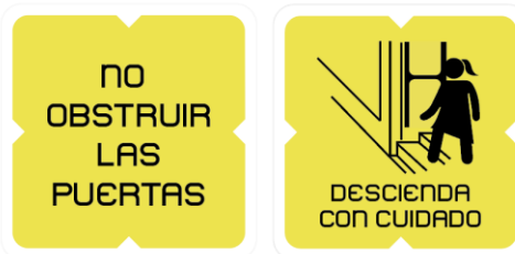
Imagen 27. Señales preventivas en puerta de descenso, cuadrados de 20 x 20 cm.
