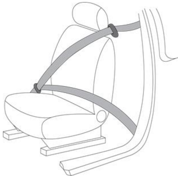
Esquema 1. Cinturón de seguridad de 3 puntos (vista del conductor)
