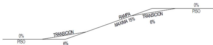
**XX.** En los estacionamientos deben existir protecciones adecuadas en rampas, colindancias, fachadas y elementos estructurales, con dispositivos capaces de resistir los posibles impactos de los automóviles.
